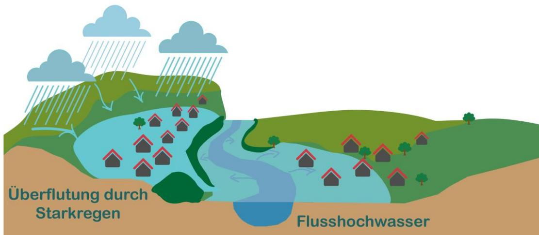
Abbildung 3: Unterschied Überflutungen infolge von Flusshochwasser (fluvial) und Starkregen (pluvial) (Quelle: ThLG)
