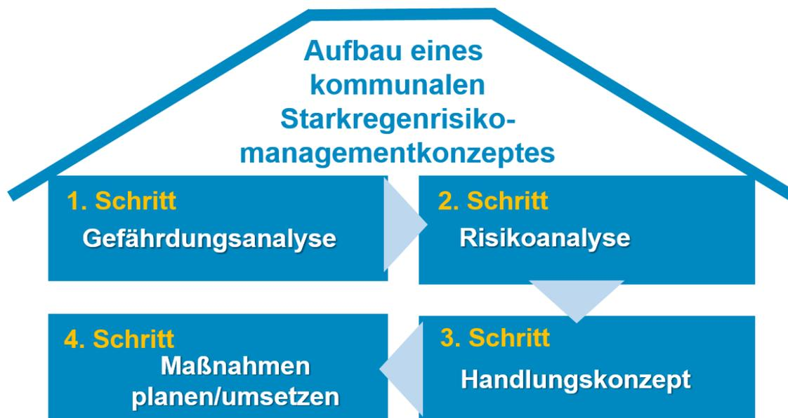
Abbildung 21: Arbeitsschritte für die Erstellung eines kommunalen Handlungskonzeptes für Hochwasser durch Starkregenereignisse (Quelle: ThLG)
